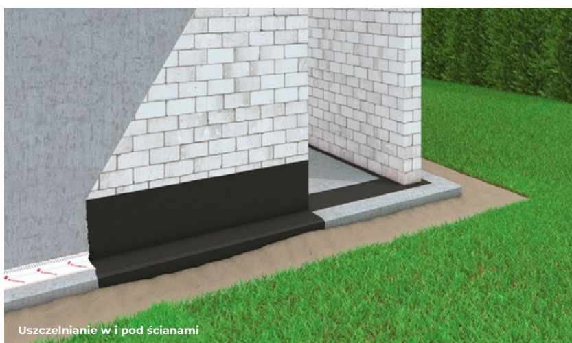
Elementy budowlane położone poniżej poziomu gruntu
